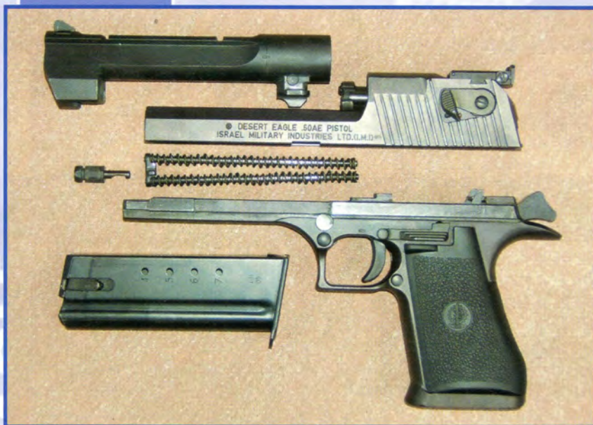
Les 6 éléments principaux de l'arme démontée. La plus petite pièce est le piston d'emprunt des gaz. On notera également le double ressort logé sous le canon.
