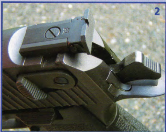
1-Culasse ouverte avec tête rotative et canon fixe. 2- Une hausse optionnelle micrométrique, ici un modèle L.P.A (Gardone, Italie).
